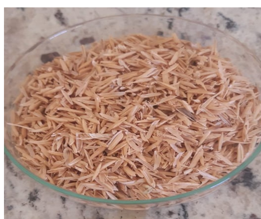
Figura 1: Imagens da casca de arroz obtidas antes da calcinação (a) e cinza de SiAr após a calcinação
