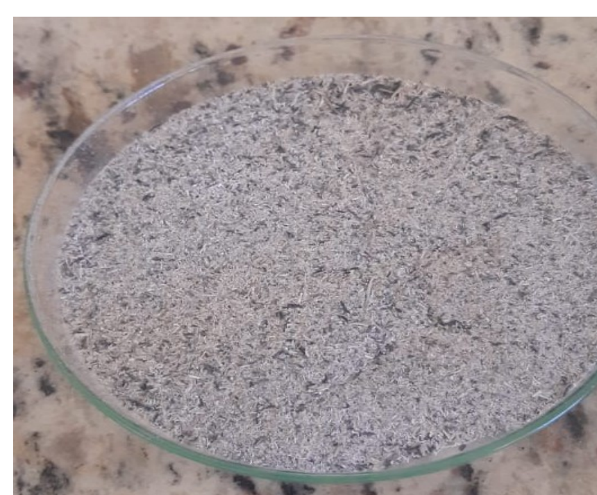
Figura 1: Imagens da casca de arroz obtidas antes da calcinação (a) e cinza de SiAr após a calcinação
