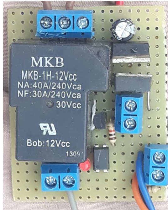
Figura 27 – Componentes montados na placa ilhada
