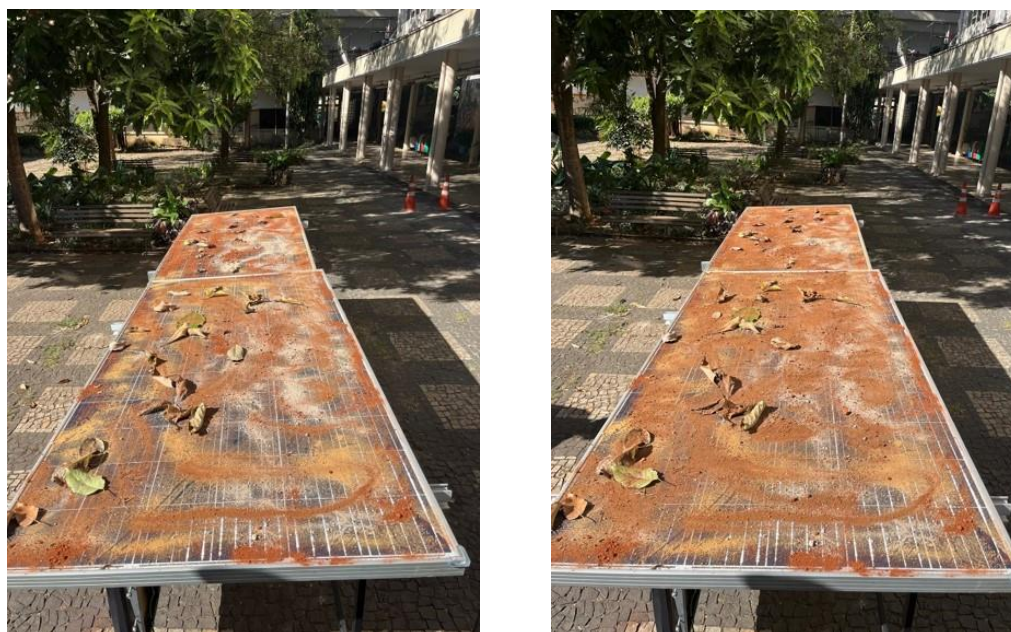
Figura 14 - Intensidade S4 e S5 de sujeira.
