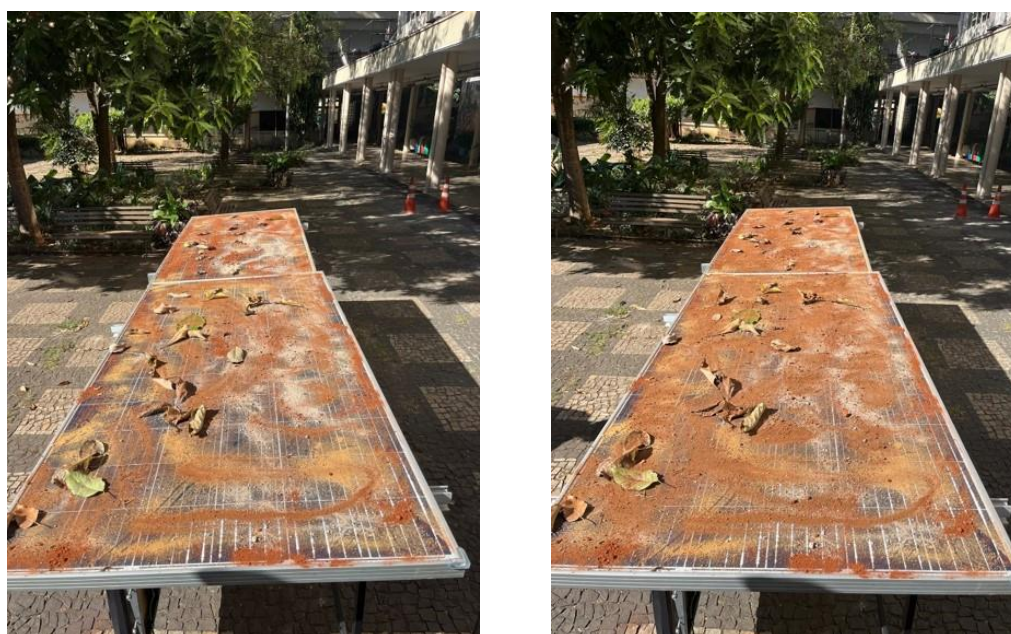
Figura 14 - Intensidade S4 e S5 de sujeira.
