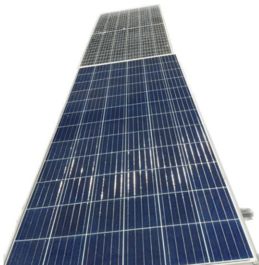
Figura 12 - Placa com sujeira residual (S1).
