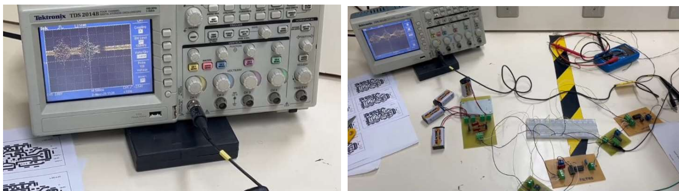
Figura 37 – Sinal EMG após estágio de offset
