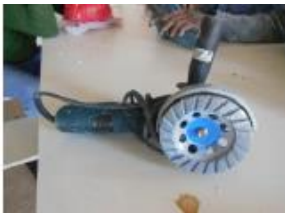
Figura 9– Esmerilhadeira com disco de desbaste
