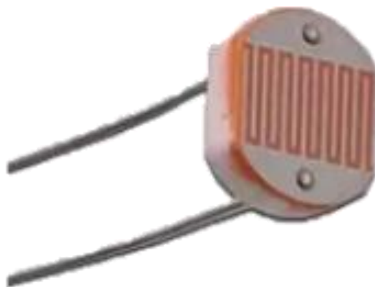
Figura 4 – Sensor Fotorresistor LDR 5528
