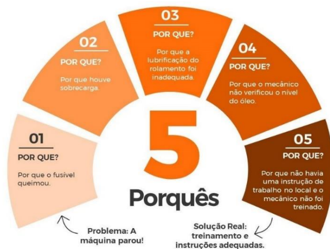
Figura 8 - Representação da aplicação dos 5 Porquês
