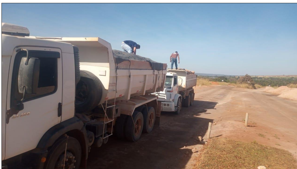
Foto 3 - Processo de enlonamento em uma jazida de argila pozolana.
