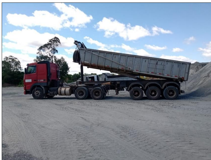
Foto 4 - Semi reboque composto por Cavalo mecânico da Volvo FH12 380 4x2T e reboque Basculante da Rossetti SRBA ST 3.25
