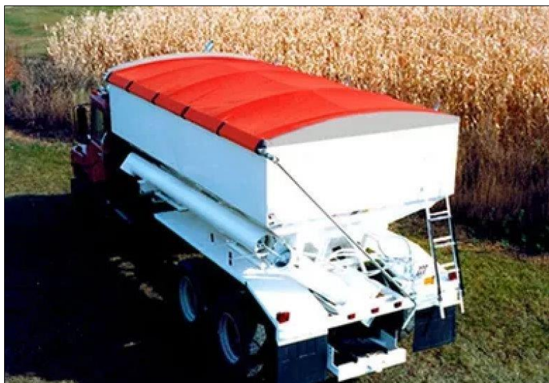
Figura 8 - Lona automática para cobertura de cargas de soja.
