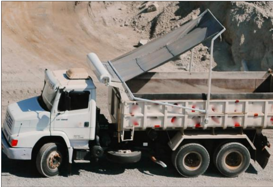
Figura 6 - Cobertura automatizada para caminhões do tipo Caçamba.
