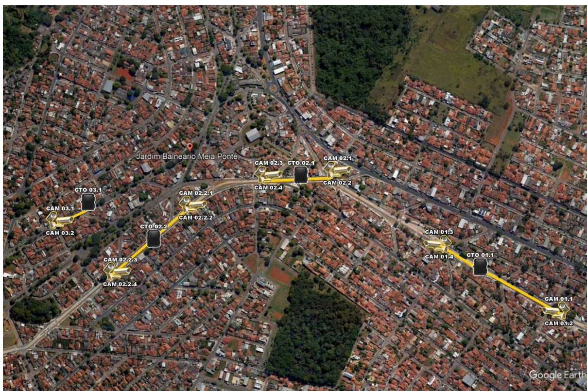
Figura 3.4 – Cabos de atendimento e Câmeras CFTV
