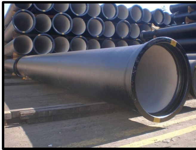
Figura 25 – Tubos de Ferro Fundido (FoFo)
