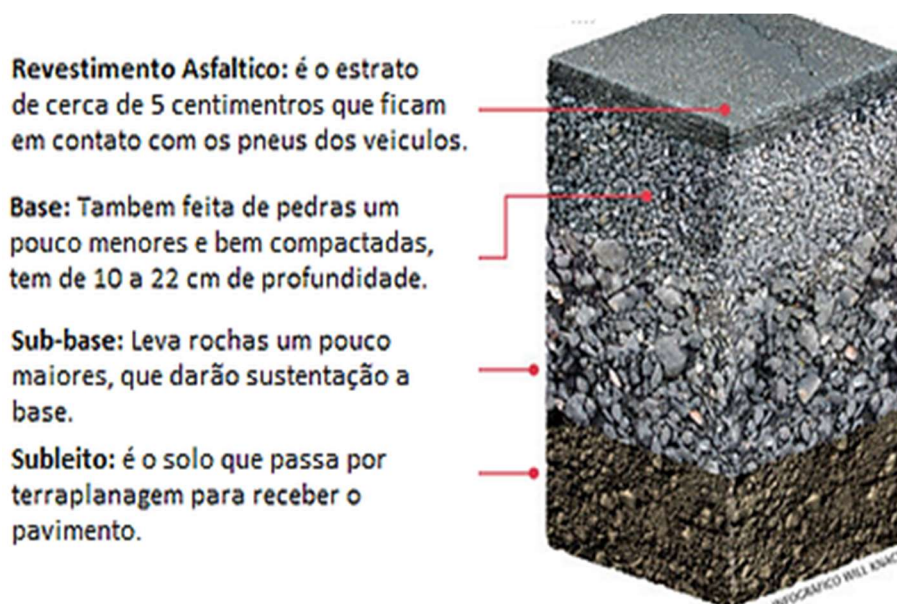
Figura 26 - Camadas do pavimento asfáltico
