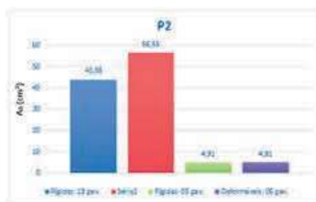
Figura 89 – Modelo de Ferreira, El Debs e Elliot (2003): armadura do pilar P2 da estrutura com 19 e 5 pavimentos, considerando ligações rígidas e ligações deformáveis Fonte: Elaborada pela autora.
