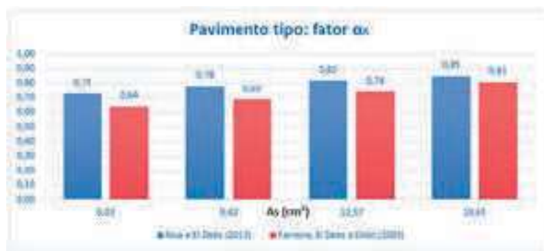
Figura 105 – Valores de fator \alpha_r das ligações do pavimento tipo, em função da armadura negativa da ligação, para os 2 modelos analíticos
