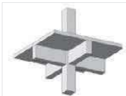
Figura 7 – Ligação viga-pilar moldada no local com a presença de laje
