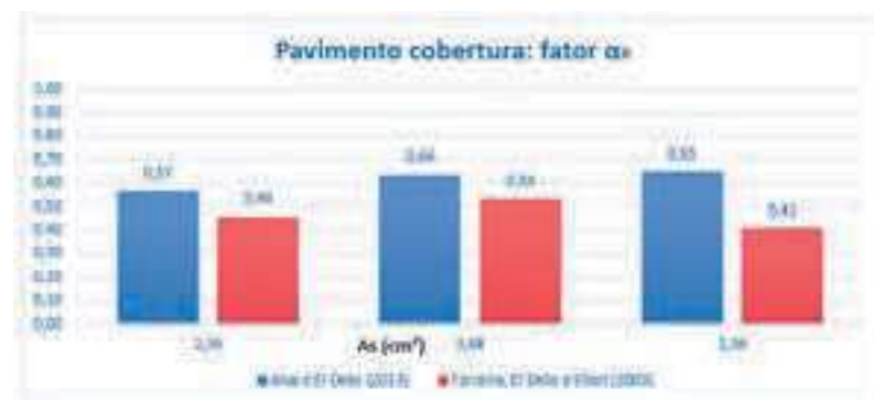
Figura 101 – Valores de fator \alpha_R das ligações do pavimento cobertura, em função da armadura negativa da ligação, para os 2 modelos analíticos
