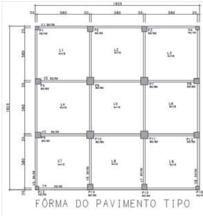
Figura 4 – Planta de formas do Edifício 2
