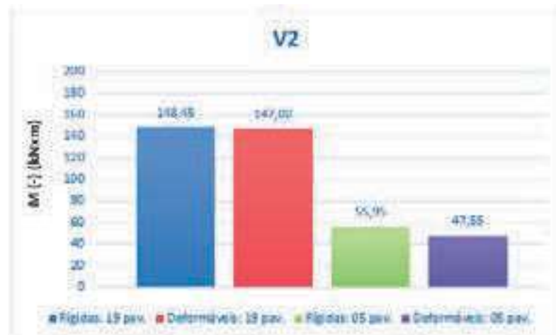
Figura 97 – Modelo de Alva e El Debs (2013): momento negativo da viga V2 da estrutura com 19 e 5 pavimentos, considerando ligações rígidas e ligações deformáveis
