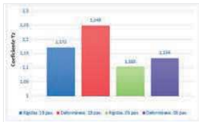
Figura 85 – Modelo de Ferreira, El Debs e Elliot (2003): coeficiente \gamma_z da estrutura com 19 e 5 pavimentos, considerando ligações rígidas e ligações deformáveis Fonte: Elaborada pela autora.
