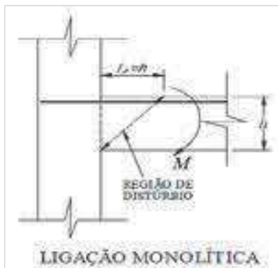
Figura 37 – Região de distúrbio na extremidade da ligação viga-pilar monolítica L_e : comprimento de embutimento, ou de ancoragem existente, conforme Figura 38. Fonte: Adaptada de Ferreira, El Debs e Elliot (2003).
