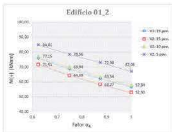
Figura 66 – Edifício 1_2: momento positivo da viga V2 versus fator \alpha_R Fonte: Elaborada pela autora.
