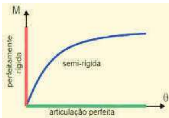
Figura 10 – Curva momento-rotação de uma ligação semirrígida
