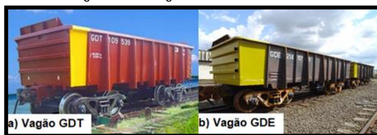
Figura 4.14 - Vagão Gondola - GDT e GDE
