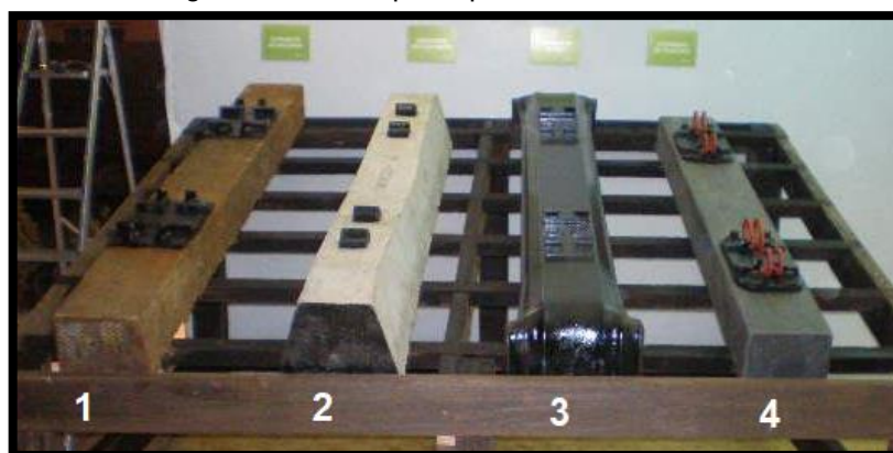
Figura 3.4 - Principais tipos dormentes em uso
