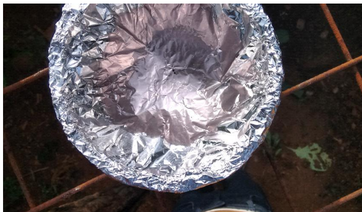
Figura 2: Fotoreator com radiação UV solar, constituído por superfície parabólica espelhada.
