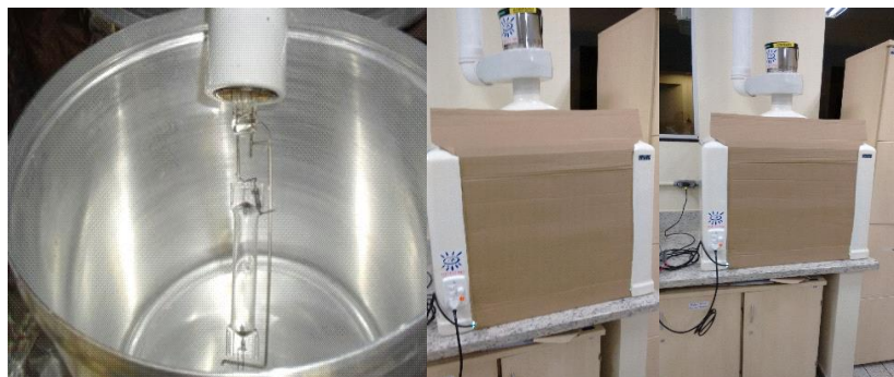
Figura 1: Fotoreator com radiação UV artificial, constituído por lâmpada de vapor de mercúrio, tubo de quartzo, célula cilíndrica metálica e reator para lâmpada.
