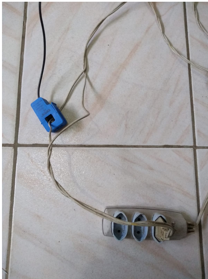
Figura 19 – SCT-013 Conectado a uma extensão
