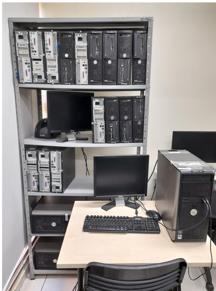
Figura 4 – Implementação Física do cluster Beowulf
