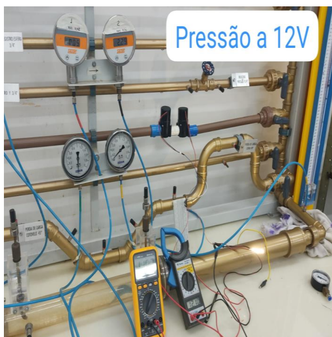
Figura 20 - Medição de Pressão 2,25bar a 12 V e 46,7 mA de corrente. Fonte: Autor, 2023.
