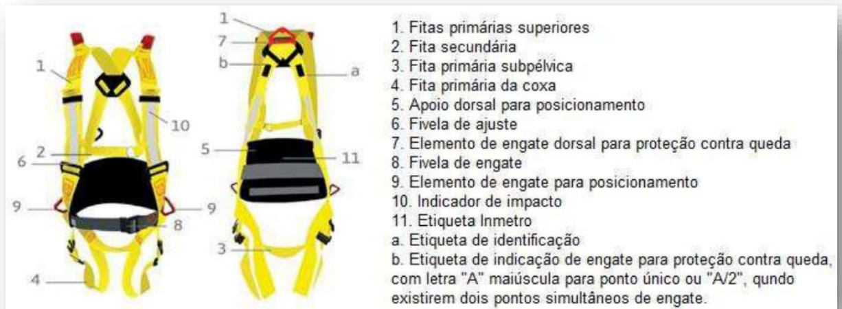
Figura 9: Cinturão tipo paraquedista.
