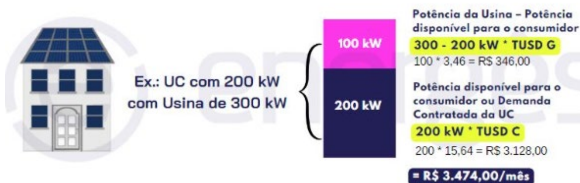
Figura 24 - Cobrança da DG para Geração junto a carga
