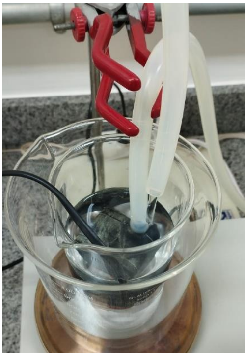
Figura 24 – Bomba de aquário e mangueiras de silicone que interferiram nos resultados, adsorvendo o clorpirifós
