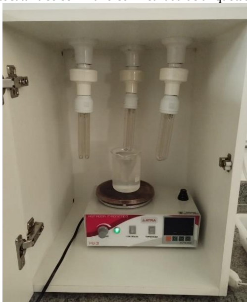
Figura 25 – Ensaio fotocatalítico sem fluxo com retirada de alíquotas direto do béquer com a solução.
