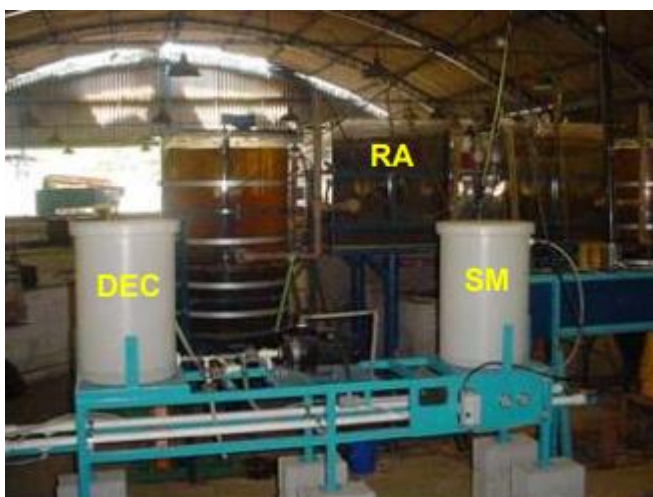
Imagem 9- Sistema de lodos ativados (reator aerado (RA), decantador (DEC) e sistema de membranas (SM)
