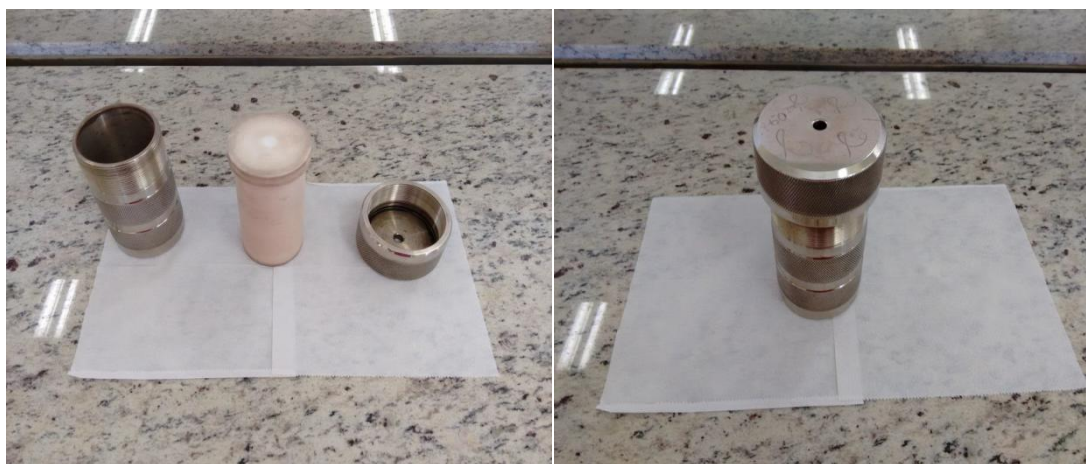
Figura 9. Imagens da autoclave utilizada na síntese dos nanotubos de \text{TiO}_2 .
