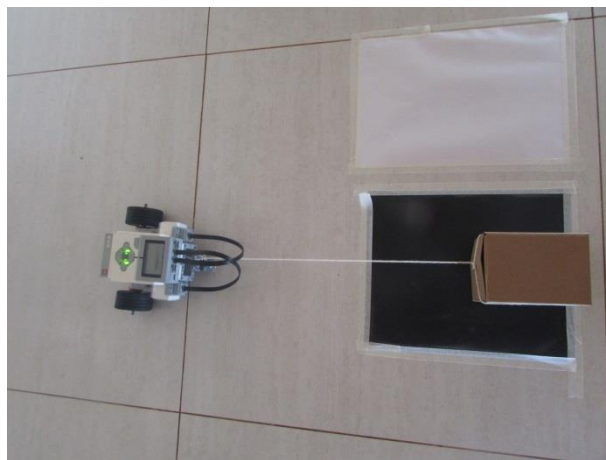
Rover arrastando carga na folha de lixa
