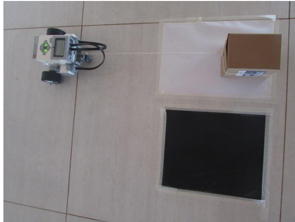
Rover arrastando carga na folha de papel
