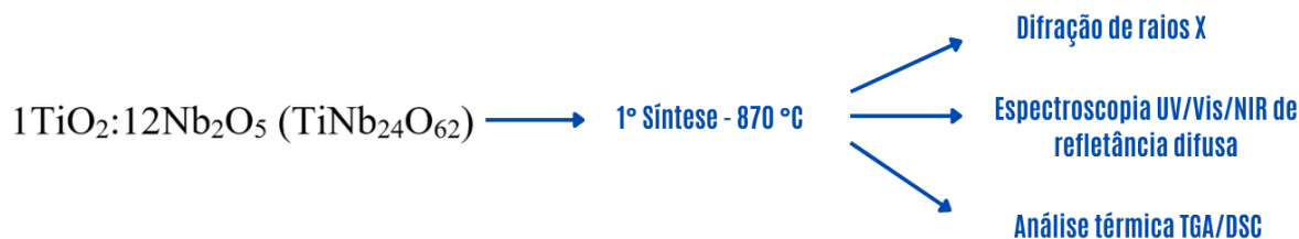
Figura 06: Fluxograma de síntese e caracterização para a amostra 1\text{TiO}_2:12\text{Nb}_2\text{O}_5 ( \text{TiNb}_{24}\text{O}_{62} ).
