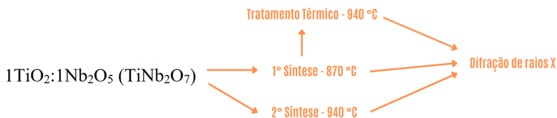
Figura 04: Fluxograma de síntese e caracterização para as amostras 1\text{TiO}_2\text{:1Nb}_2\text{O}_5 ( \text{TiNb}_2\text{O}_7 ).
