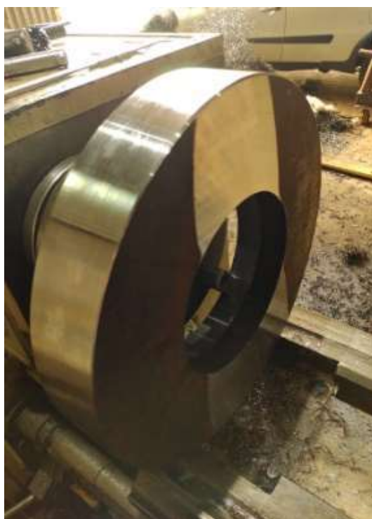
Figura 5.2 - Defeito na face da chapa de 3" de espessura (empenamento). Fonte: Autoria Própria.
