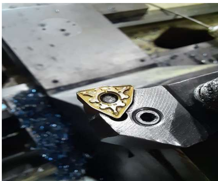
Figura 4.2 - Ferramenta de corte de metal duro WNMG 060408, com revestimento TiN. Fonte: Autoria própria.
