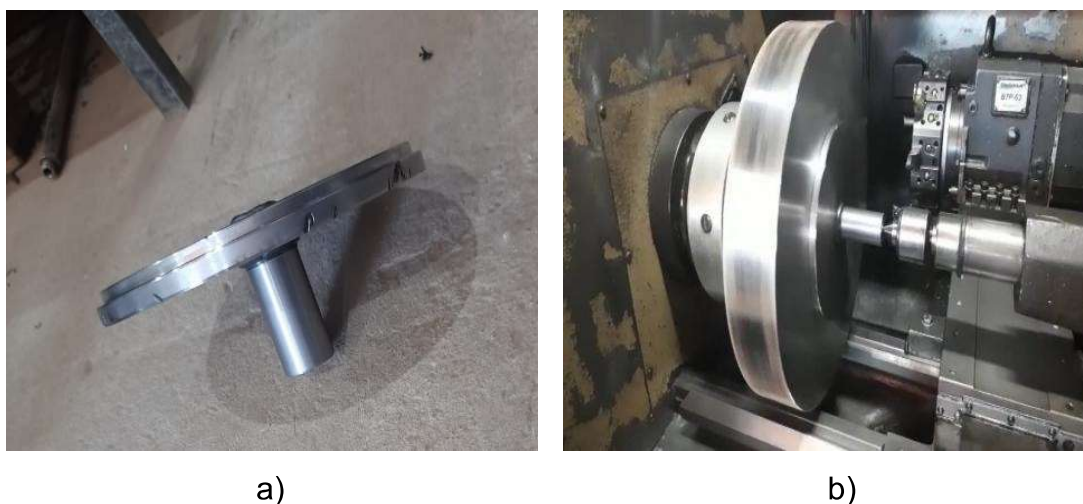
Figura 4.6 - Sistema de fixação com um suporte especial no contra ponto: a) contra ponto; b) contra ponto fixado no torno. Fonte: Autoria própria.
