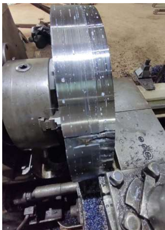
Figura 5.1 - Riscos na extremidade superior dos acoplamentos devido ao corte com plasma. a) e b). Fonte: Autoria Própria.
