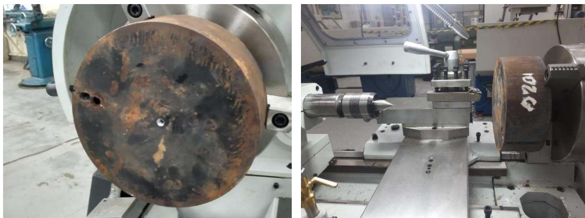
Figura 4.10 - Corpo de prova cilíndrico em aço SAE 1020 utilizado nos ensaios. Fonte: Autoria própria.
