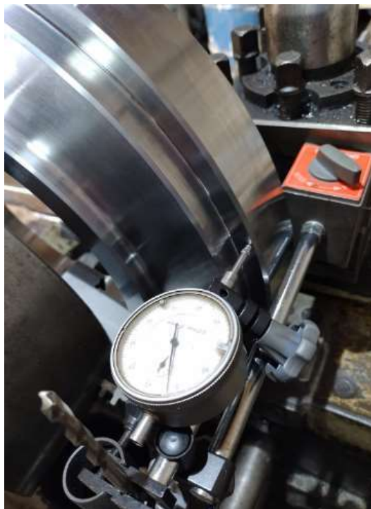
Figura 4.7 - Relógio comparador utilizado para centralização das peças. Fonte: Autoria própria.
