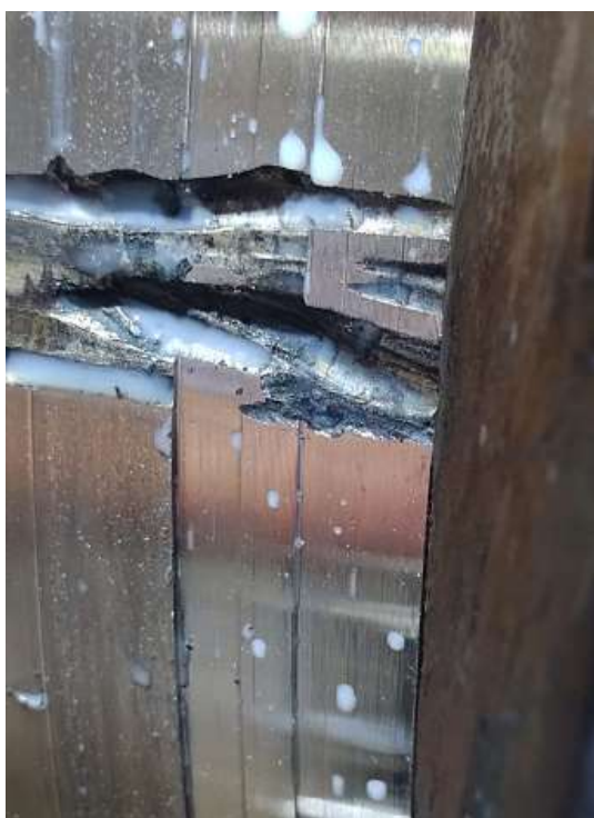
Figura 5.1 - Riscos na extremidade superior dos acoplamentos devido ao corte com plasma. a) e b). Fonte: Autoria Própria.
