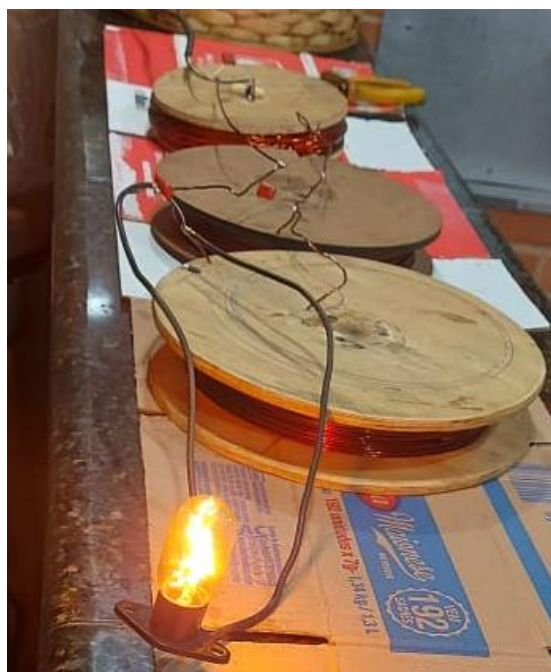
Figura 3.11 – Foto dos testes com as bobinas construídas
