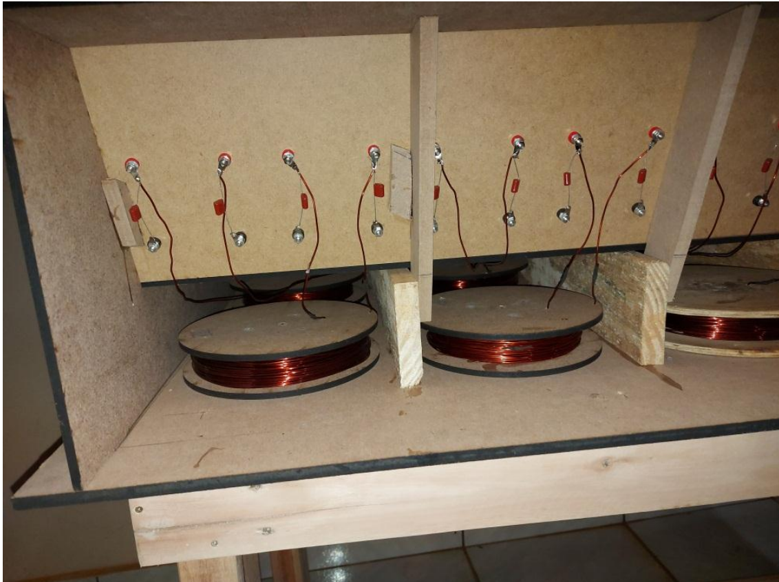
Figura 3.18 – Foto da instalação das células no painel da bancada
