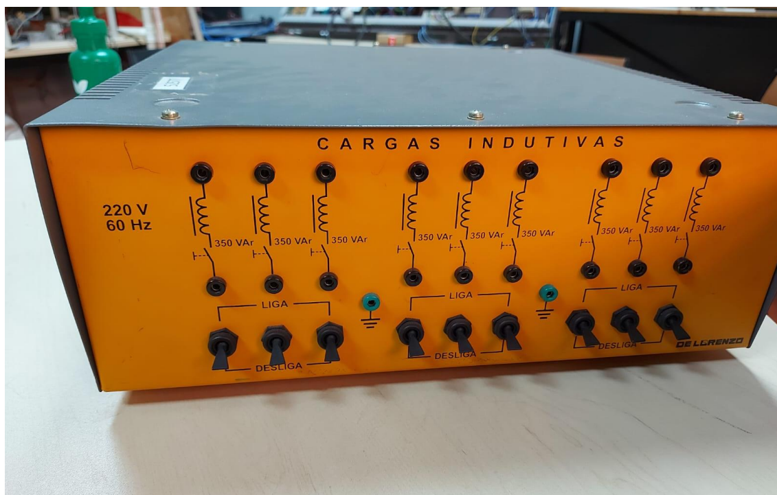
Figura 4.3 - Foto do painel de cargas indutivas utilizado
