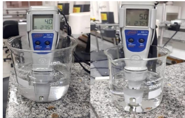
Figura 05 – Ajuste do pH para simulação de chuva ácida.
