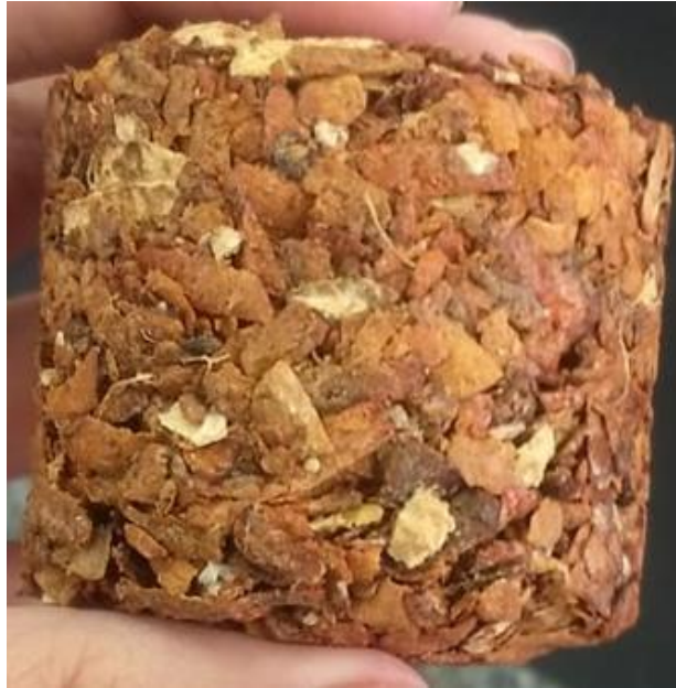
Figura 24: MDF desinformado sem resina.
