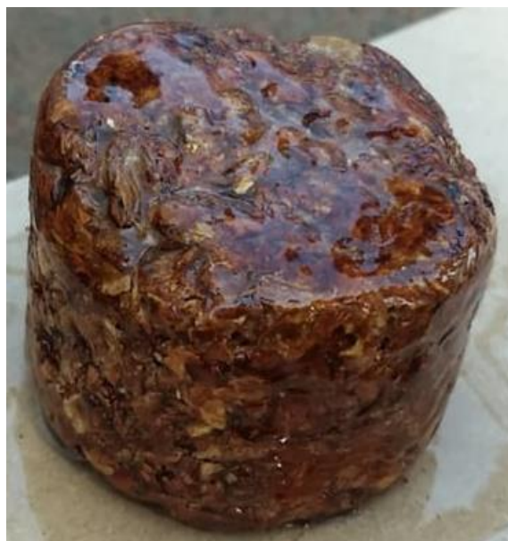
Figura 25: MDF com a resina aplicada.
