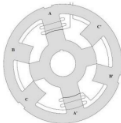
Figura 2.1: Seção transversal de uma MRV trifásica 6x4, mostrando o enrolamento da fase A.
