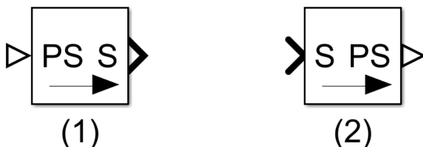
Figura 6.1: Em (1) vemos o bloco responsável por converter sinais físicos para sinais Simulink , em (2) temos a operação contrária.
