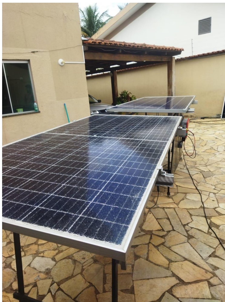
Figura 42 - Bancada no experimento 0°
