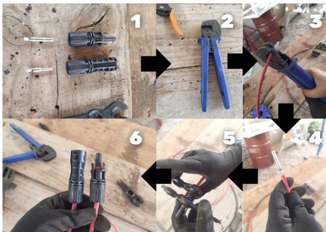
Figura 38 - Passo a Passo crimpagem do terminal MC4
