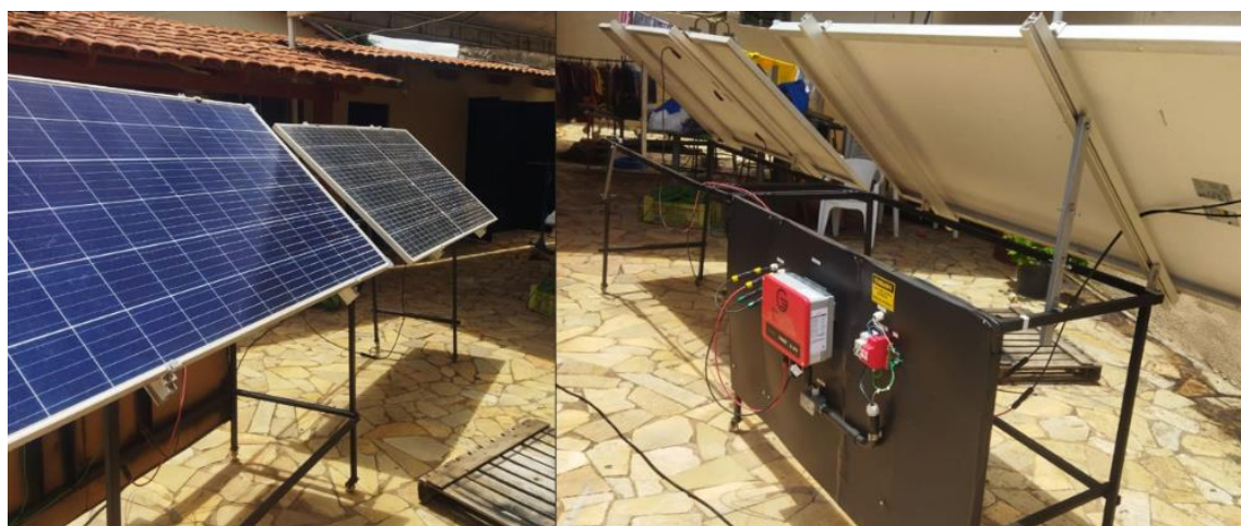
Figura 46 - Módulos e bancada no quarto experimento com 45°.
