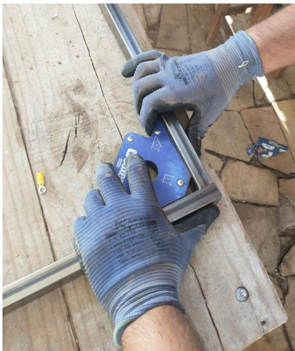
Figura 36 - Utilização do esquadro magnético.
