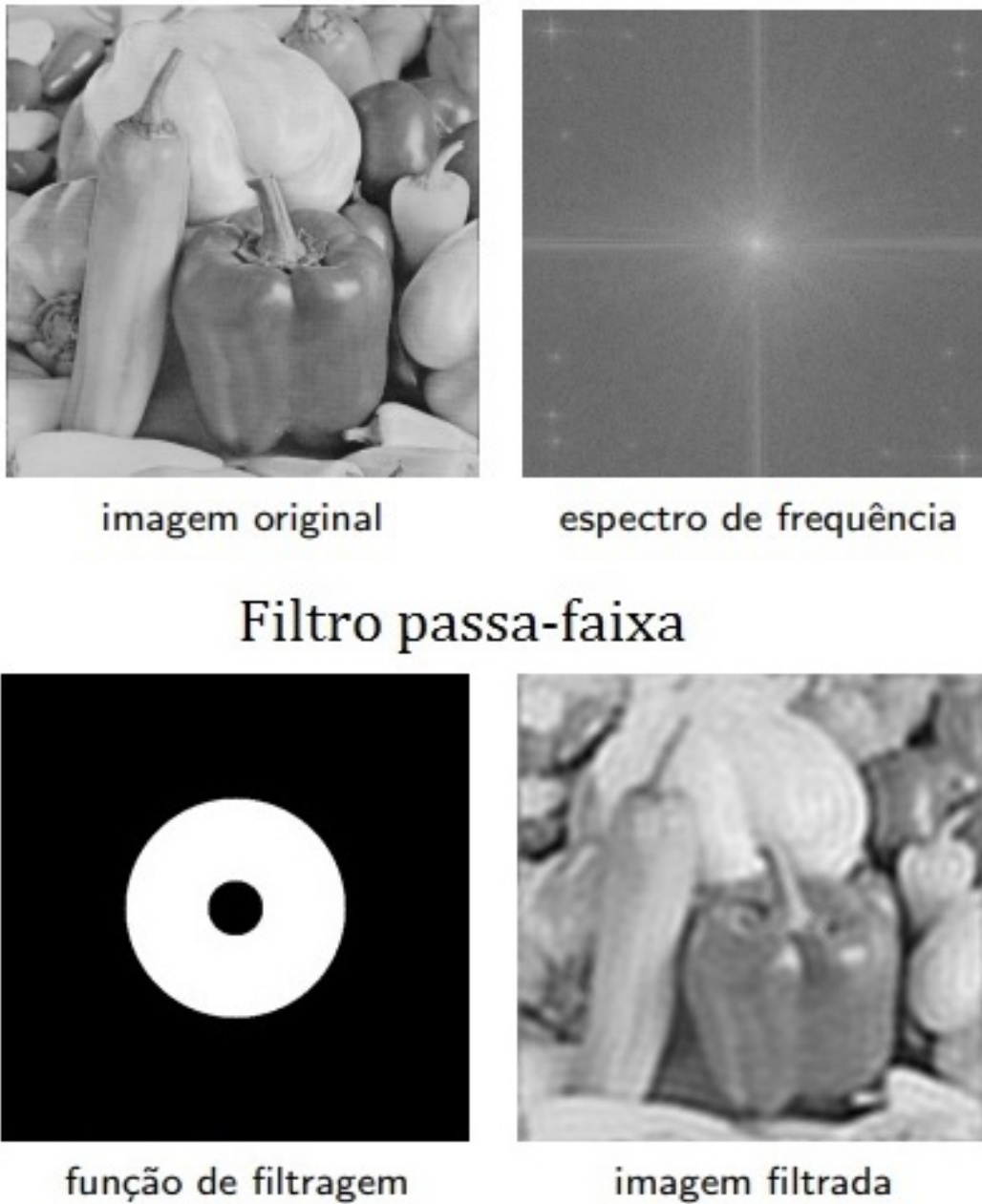
Figura 4.8: Figura modificada de (PEDRINI, 2022) com imagem de entrada, dos espectros de frequências, do filtro passa-faixa e da imagem de saída.
