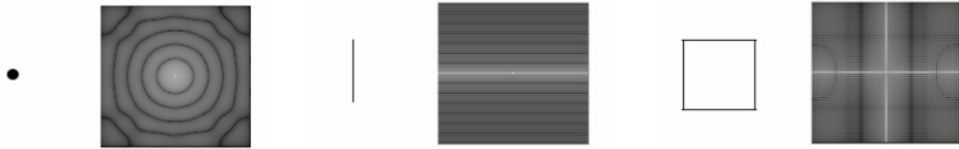
Figura 4.4: Figura modificada de (CONCI, 2018) com imagens representadas como funções bidimensionais e seus respectivos espectros de Fourier.
