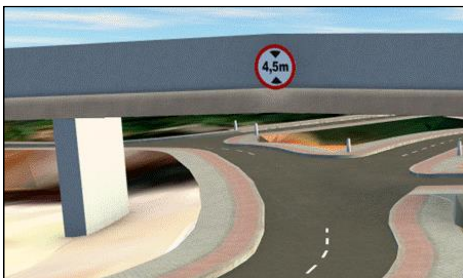
Figura 71 - Simulação de implantação de Placa R-15 – Altura máxima permitida.
