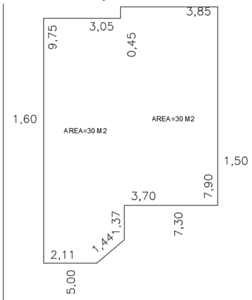
Figura 12 - Área do telhado
