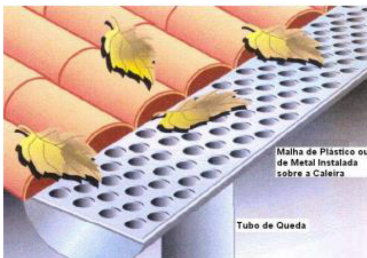
Figura 3 - Malha instalada sobre caleira
