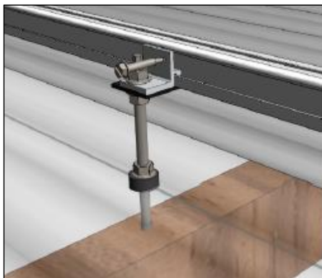
Figura 56: Fixação do parafuso estrutural madeira
