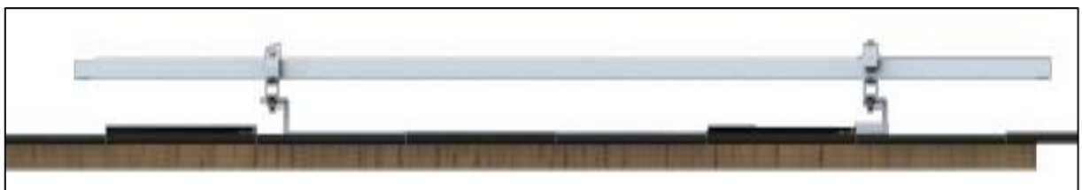
Figura 63: Aplicação do suporte shingle.
