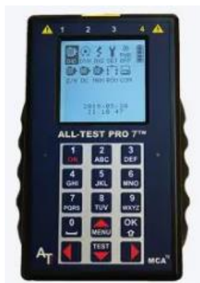
Figura 4.4 – Instrumento de teste de análise de circuito de motor desenergizado AllTest-Pro (ALLTES, 2019).
