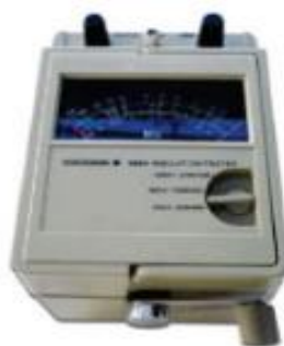
Figura 4.1 – Vista do megômetro analógico (YOKOGAWA, s.d.).
