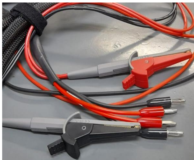
Figura 5.10 – Baker AWA-IV – Item 11 Conexão Ponte Kelvin (MEGGER, 2019).
