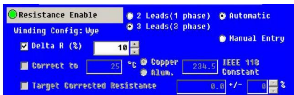
Figura 5.14 – Configuração de parâmetros porcentagem de falha ( Delta R ) (MEGGER,2019)
