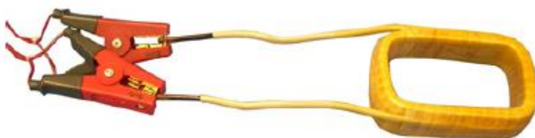
Figura 4.9 – Bobina interpolar para representar a medição surge test (MEGGER, 2013).
