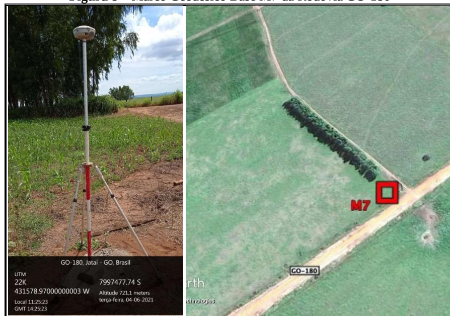
Figura 8 – Marco Geodésico Base M7 da Rodovia GO-180
