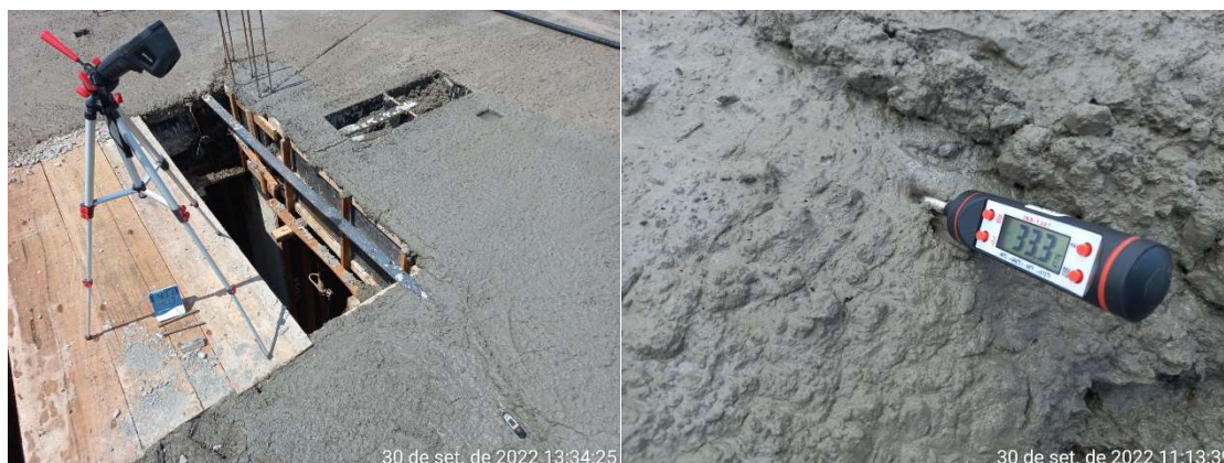
Figura 19 - (a) posicionamento da câmera térmica e higrômetro (b) Posição do termômetro
