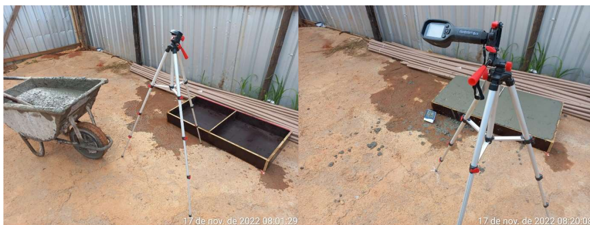
Figura 22 - Posicionamento câmera térmica em campo
