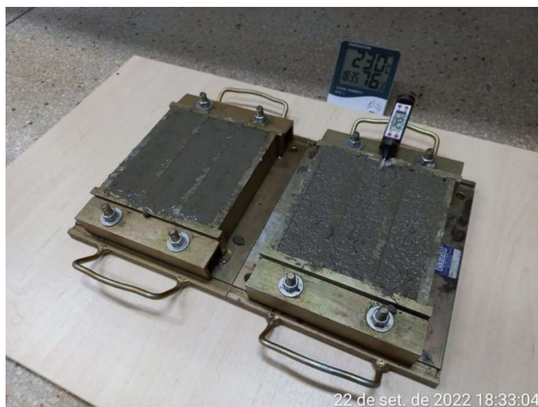
Figura 16 - Protótipos em formas de argamassa
