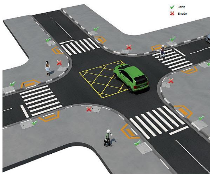
Figura 24- Instalação de bocas de lobo
