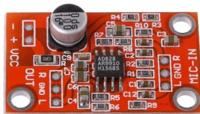
Figura 16 - Pré Amplificador Para Microfone Dinâmico 2 Canais
