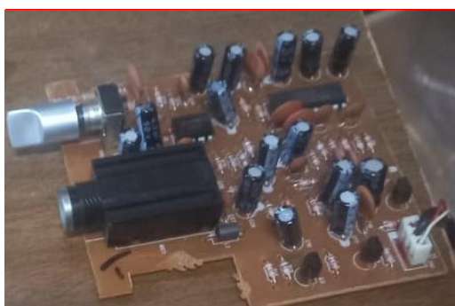
Figura 15 - Amplificador de microfone retirado do DVD
