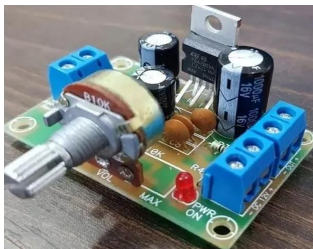
Figura 9 Amplificador Mono 10w Rms 12v Tda2003 - Modelo 2019
