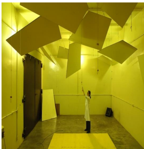
Figura 1 - Câmara de reverberação
