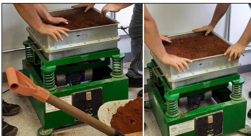
Figura 2. Preparo do solo no agitador elétrico
