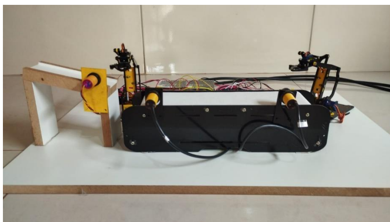
Figura 39 — Posição dos sensores infravermelhos
