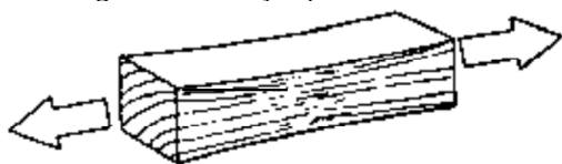
Figura 2.6 - Tração paralela às fibras
