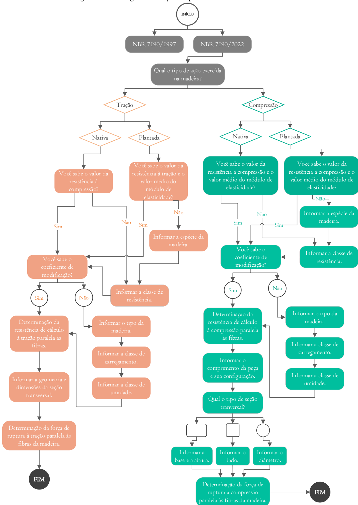
Figura 5.9 - Fluxograma do software pela NBR 7190/2022
