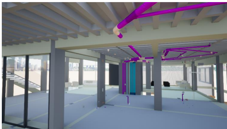
Figura 17 – Furo em viga da tubulação de esgoto da suíte master
