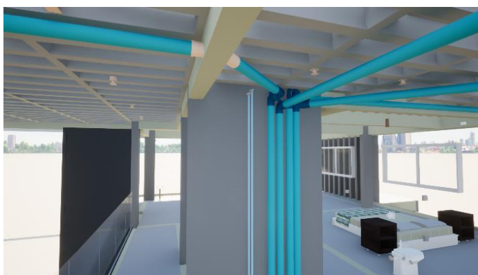
Figura 18 – Furo em viga da tubulação de água pluvial
