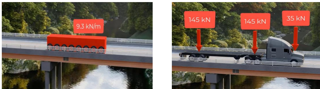
Figura 50 e 51 - Carga de Pista Designada de 9,3 \text{ KN/m} e Carga de Caminhão Designada
