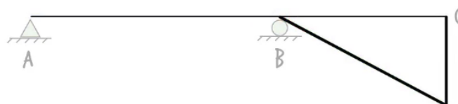
Figura 37 – Exemplo de Linha de Influência para Momento em B
