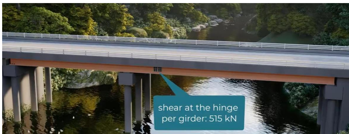
Figura 76 – Esforço de Cisalhamento Máximo encontrado na rótula
