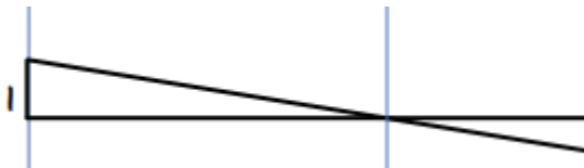
Figura 14 - Linha de Influência para Reação no apoio em A
