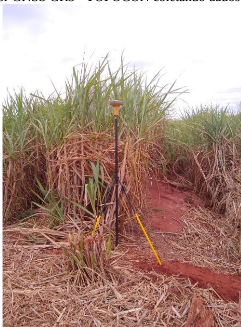
Figura 10 – Receptor GNSS GR3 - TOPOCON coletando dados no limite do talhão.
