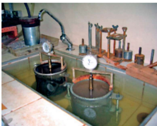
Figura 6 - Etapas do ensaio ISC.
