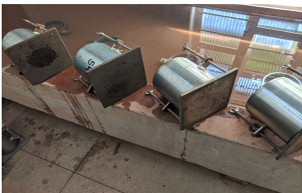
Figura 36 - Preparação e rompimento dos CPs para obtenção do CBR.
