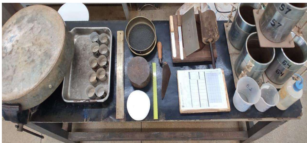
Figura 26 - Equipamentos utilizados no ensaio de compactação.
