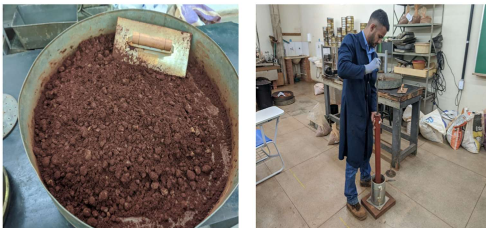
Figura 27 - Homogeneização e compactação dos corpos de provas.
