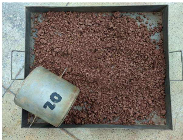
Figura 14 - Corpo de prova desmanchado e levado para secagem ao ar livre.
