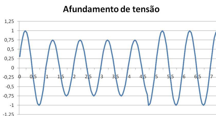
Figura 4.2: Exemplo de sinal com afundamento de tensão.
