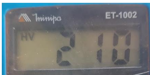
Figura 5.9: Tensão lida pelo multímetro digital no Local 1.
