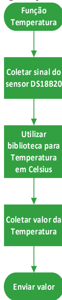
Figura 59 - Fluxograma para o sensor DS18B20
