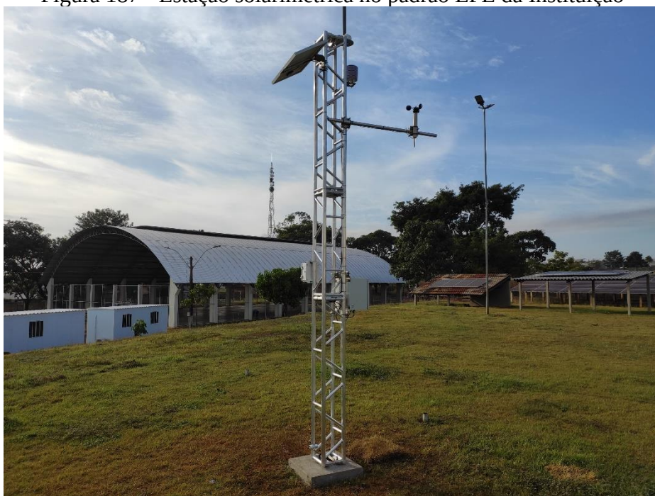
Figura 187 - Estação solarimétrica no padrão EPE da Instituição
