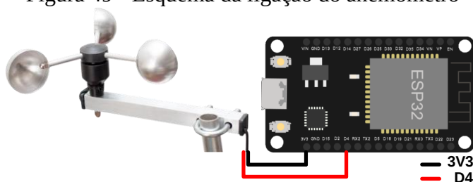
Figura 49 - Esquema da ligação do anemômetro
