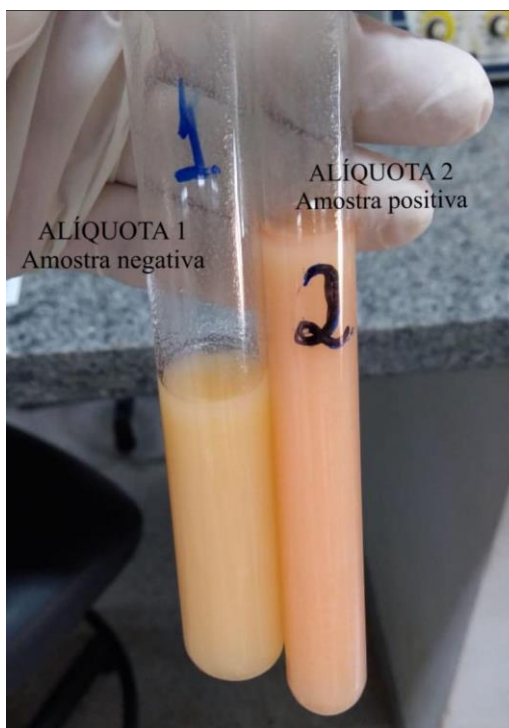
Figura 02 – Análise para o teste da presença de bicarbonato de sódio.
